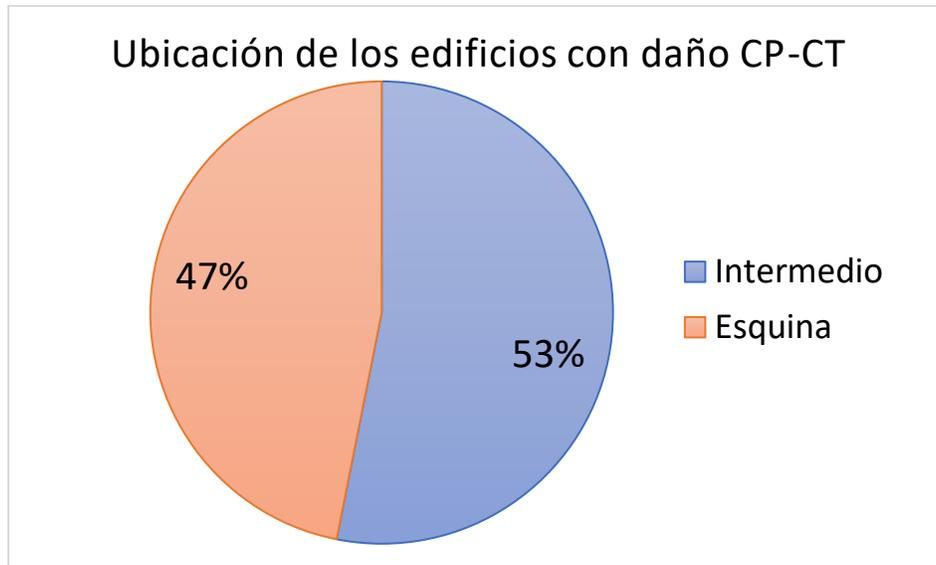
*Figura 20 Ubicación de los edificios con colapso parcial y total*
