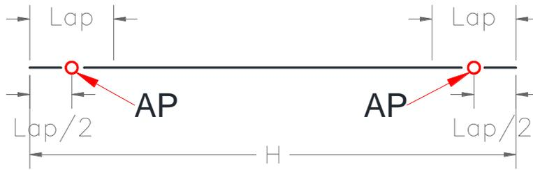
Figura 104 Componentes de un elemento estructural biarticulado con articulación plástica concentrada
