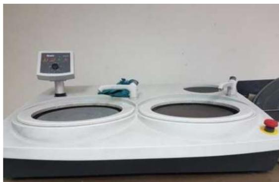
Figura 5. Tornamesa Struers modelo labosystem.
