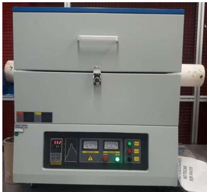
Figura 11. Horno de tubo para tratamiento térmico.
