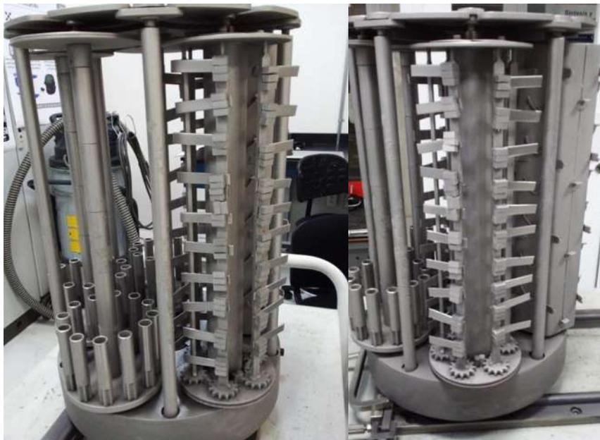
Figura 8. Sistema planetario con rotación de tres ejes.
