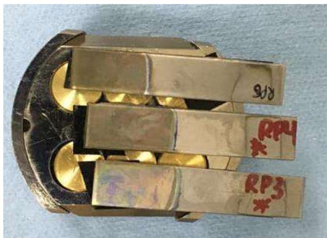
Figura 14. Muestras montadas para analizar en el microscopio electrónico de barrido.
