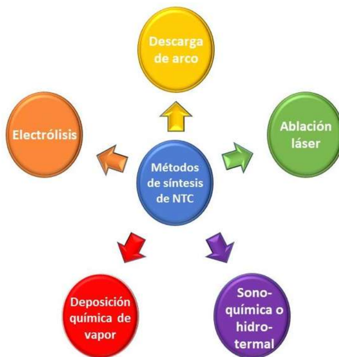
Figura 2.2. Principales métodos actualmente utilizados para la síntesis de nanotubos de carbono.
