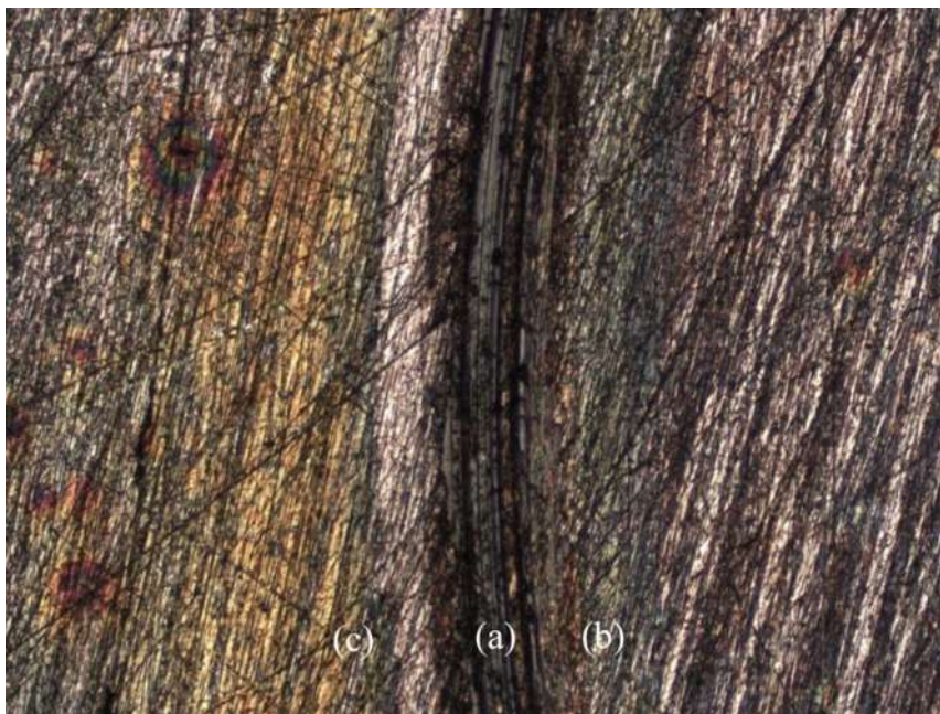
Figura 4.20. Detalle de la huella de contacto del blanco acero-acero con agua como medio de contacto tribológico. (a) Dentro de la huella de desgaste. (b) Zona interior de la huella. (c) Zona exterior de la huella.
