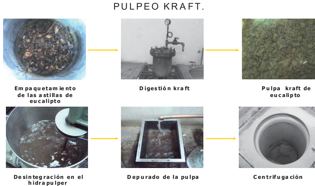
Figura 7.6. Secuencia que muestra la digestión kraft.
