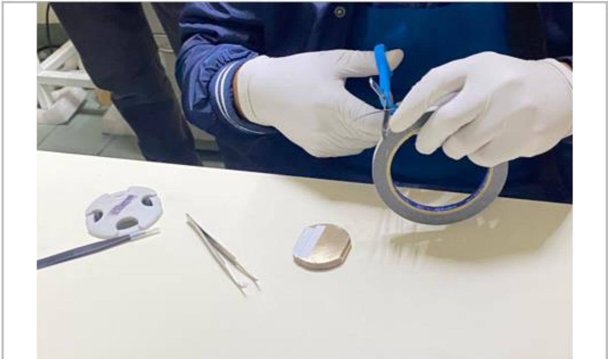
Fig. 15 Ajuste de cinta adhesiva de carbono conductora de doble cara en el porta muestras. Fotografía tomada en el laboratorio de microscopía electrónica del Instituto de Investigación en Metalurgia y Materiales de la U.M.S.N.H. Imagen propia.
