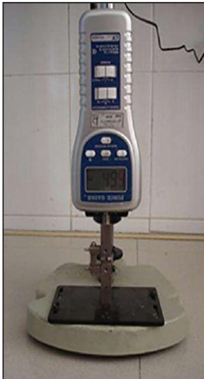
Figura 13. Fuente: Omidkhoda et al., 2015. Acoplamiento de medidor de fuerza con plantilla. La distancia entre los postes se mantuvo constante mientras se transfirió al calibre.
