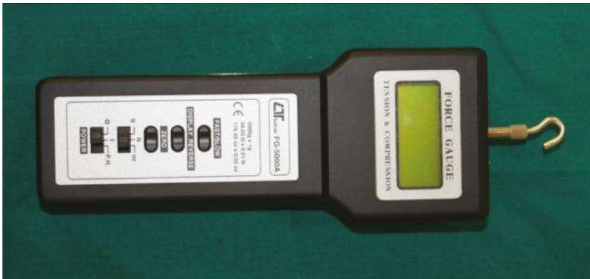
Figura 19. Fuente: Menon et al., 2019. Probador de fuerza Lutron FG-5000 A.
