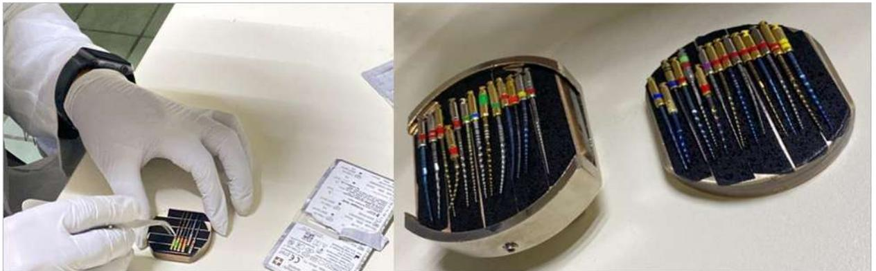
Fig. 10 Colocación de las limas en el porta muestras del Microscopio Electrónico de Barrido. Fotografía tomada en el laboratorio de microscopía electrónica del Instituto de Investigación en Metalurgia y Materiales de la U.M.S.N.H. Imagen propia.
