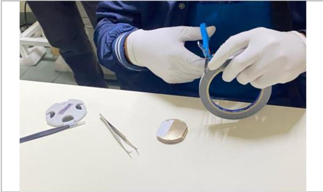
Fig. 7 Ajuste de cinta adhesiva de carbono conductora de doble cara en el porta muestras. Fotografía tomada en el laboratorio de microscopía electrónica del Instituto de Investigación en Metalurgia y Materiales de la U.M.S.N.H. Imagen propia.
