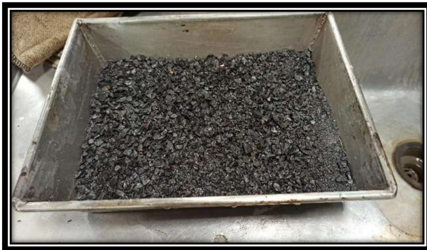
Fig. 37 Agregado después del lavado (Elaboración propia, 2023)
