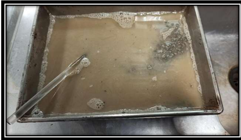
Fig. 36 Lavado del agregado (Elaboración propia, 2023)
