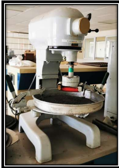
Fig. 30 Equipo implementado para la prueba WTAT (Elaboración propia, 2023)
