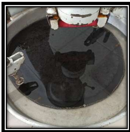
Fig. 51 Preparación de la muestra para la prueba WTAT (Elaboración propia, 2023)
