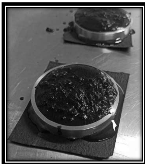
Fig. 26 Fabricación de las pastillas para la prueba de cohesión (Elaboración propia, 2023)
