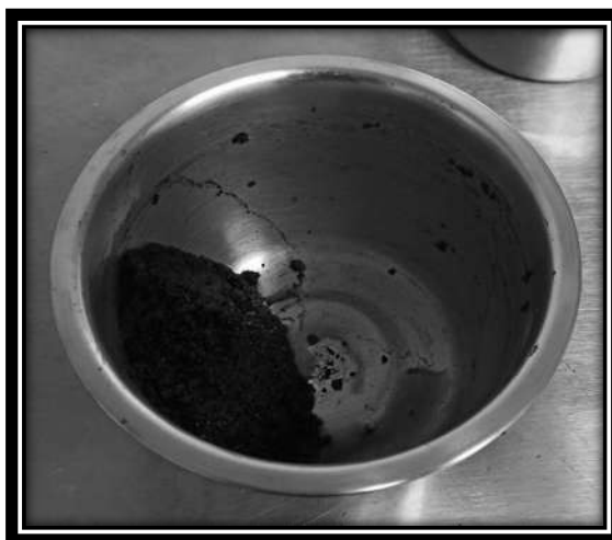
Fig. 25 Momento de la ruptura de la emulsión asfáltica (Elaboración propia, 2023)
