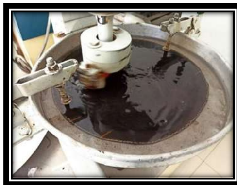
Fig. 52 Desarrollo de la prueba WTAT (Elaboración propia, 2023)
