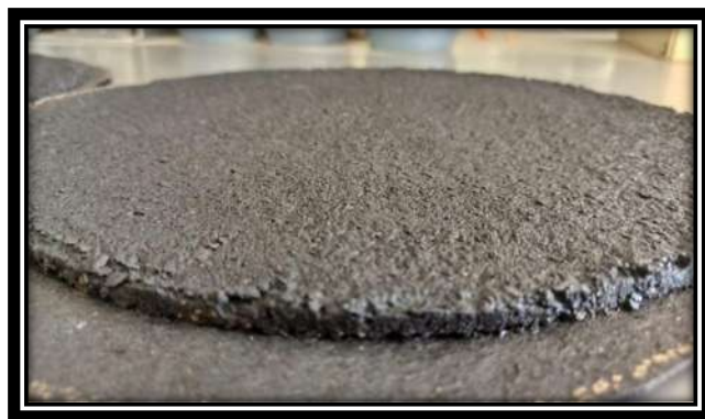
Fig. 50 Especimen para la prueba WTAT después de secar en el horno (Elaboración propia, 2023)
