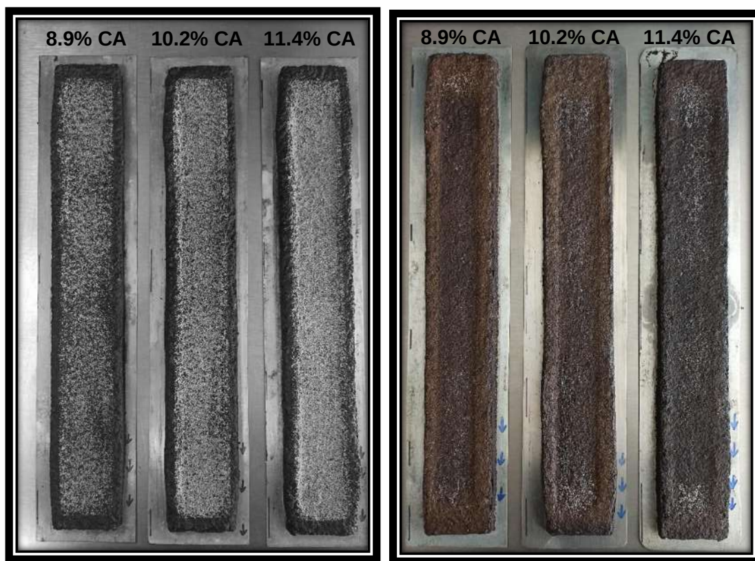
Fig. 74 Especímenes Agremex con arena adherida (Elaboración propia, 2023)
