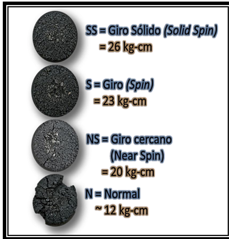
Fig. 27 Inspección visual de los modos de ruptura (KAO, 2021)
