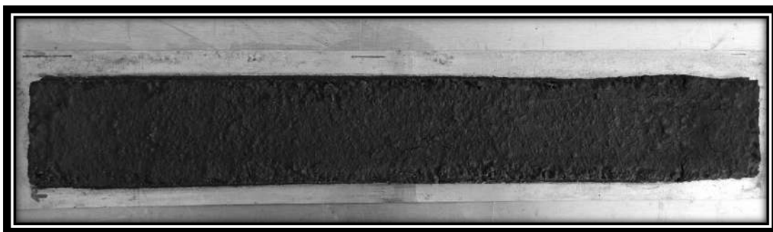
Fig. 48 Espécimen para prueba de rueda cargada (LWT) (Elaboración propia, 2023)
