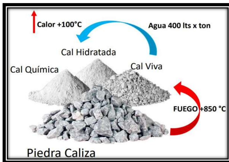
Fig. 23 Proceso de obtención de los diferentes tipos de cal (Cordero, Serment, & de la Cruz)
