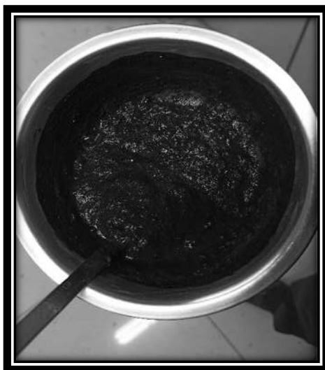
Fig. 41 Mezclado de los elementos del microaglomerado (Elaboración propia, 2023)
