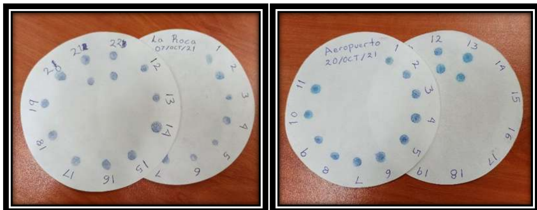
Fig. 57 Resultados azul de metileno La Roca y Aeropuerto (Elaboración propia, 2023)
