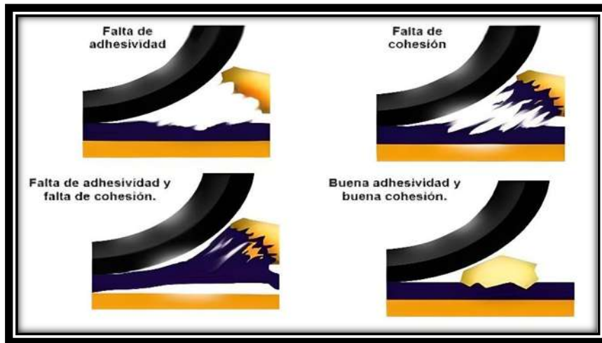
Fig. 20 Adhesión y cohesión del asfalto (DOCPLAYER, 2019)
