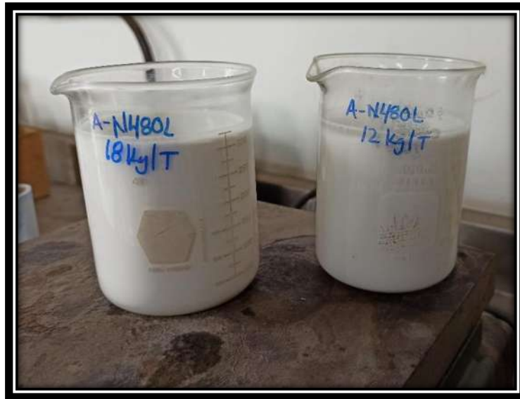
Fig. 33 Fase acuosa para la fabricación de la emulsión (Elaboración propia, 2023)
