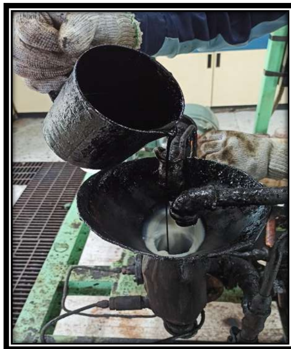
Fig. 34 Fabricación de la emulsión asfáltica (Elaboración propia, 2023)
