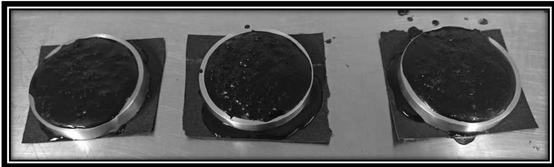
Fig. 45 Fabricación de los especímenes para la prueba de cohesión (Elaboración propia, 2023)
