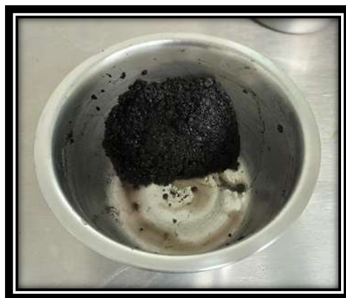
Fig. 42 Mezcla después de la ruptura de la emulsión (Elaboración propia, 2023)
