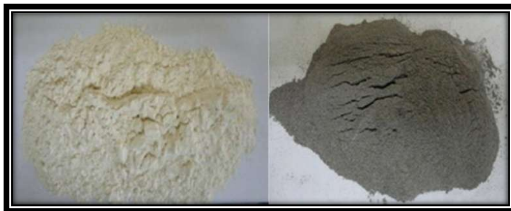
Fig. 21 Tipos de filler mineral. (Cal lado izquierdo, Cemento lado derecho) (Sarsam & Jlalil, 2015)
