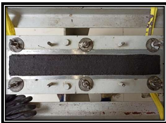
Fig. 28 Preparación del espécimen para la prueba en la rueda cargada (Elaboración propia, 2023)
