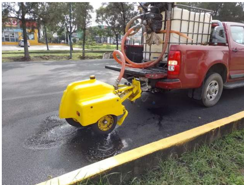
Figura 30. Equipo de medición del CF, Mu meter (propiedad de PEPSA). Fuente: Captura propia.
