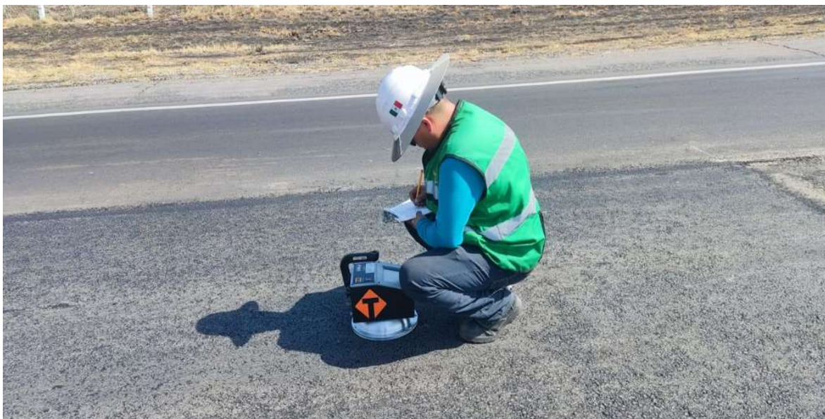
Figura 13. Determinación de la densidad de la mezcla asfáltica compactada, mediante densímetro electromagnético. Fuente: imagen capturada por autor.
