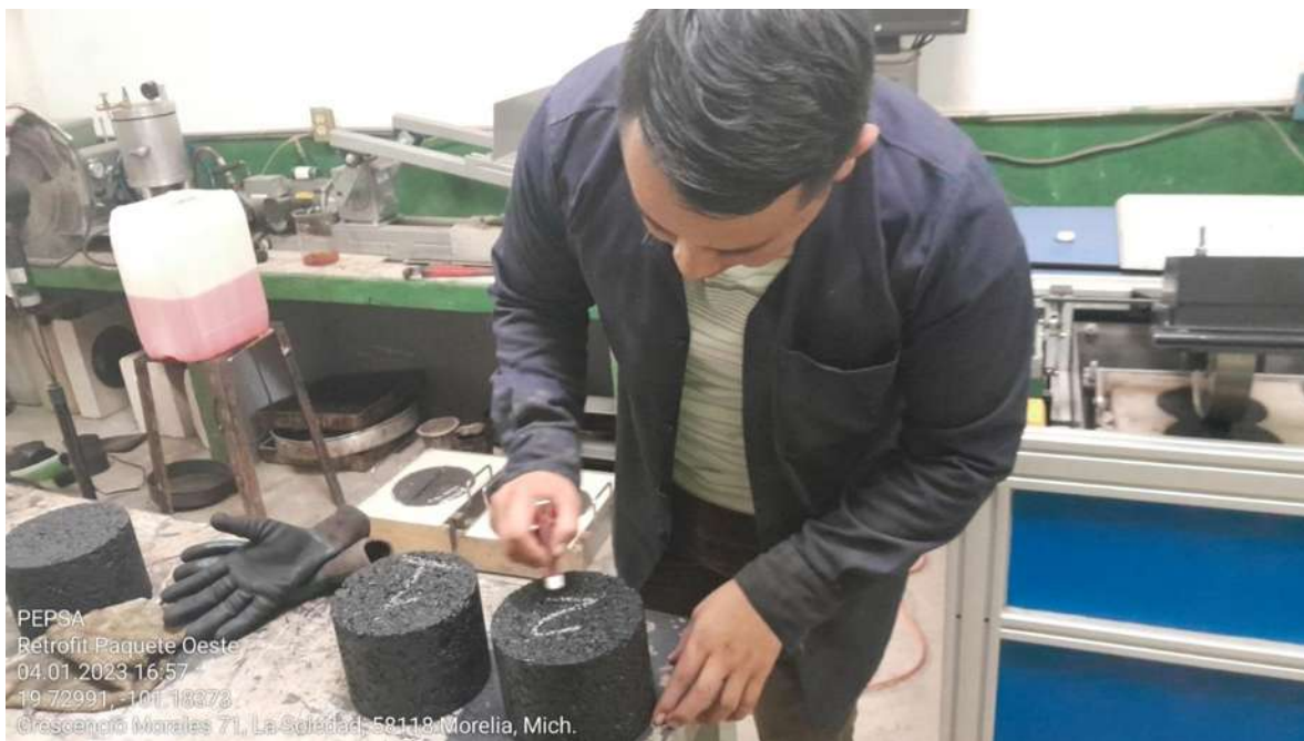
Figura 13. Fabricación de especímenes para verificación de propiedades volumétricas. Fuente: imagen capturada por autor.
