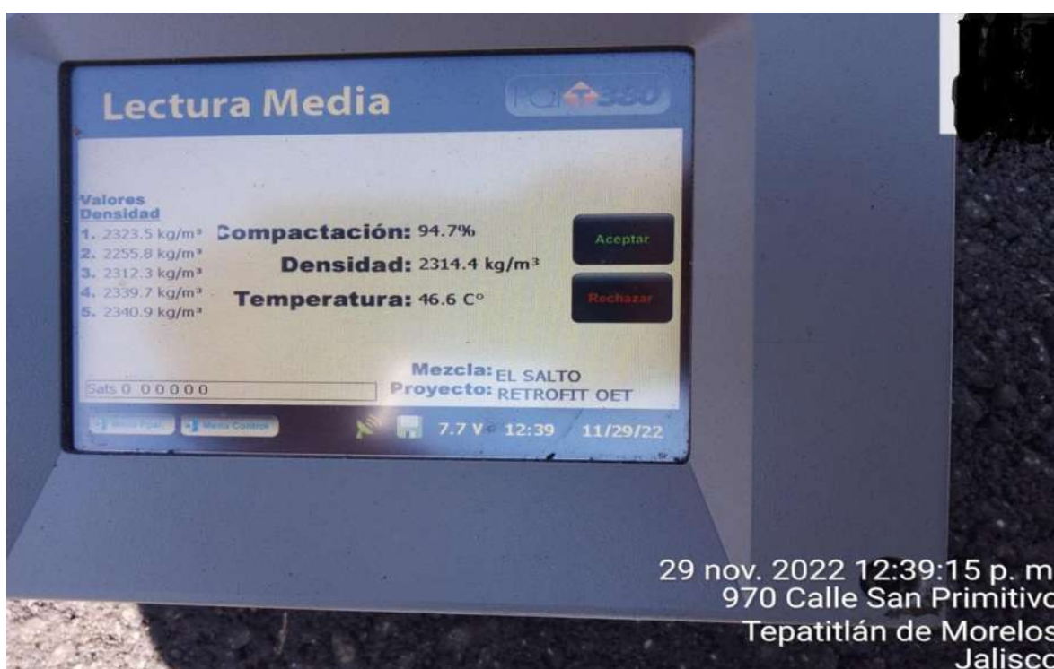
Figura 14. Verificación del grado de compactación de la mezcla asfáltica, mediante densímetro electromagnético. Fuente: imagen capturada por autor.
