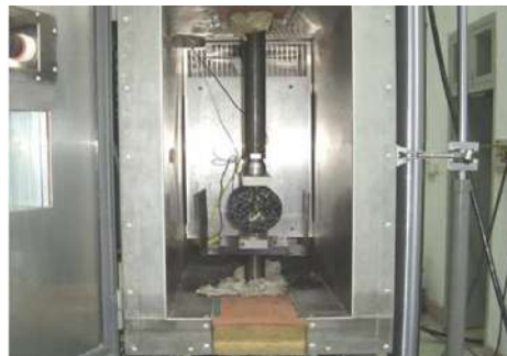
Figura 11. Ensayo de tracción indirecta. Fuente: Weidong, 2006.
