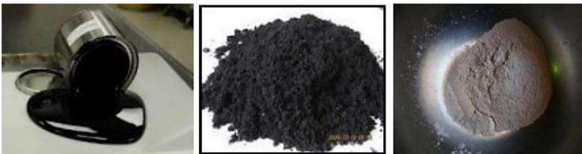
Figura 5. Componentes del RAR, de izquierda a derecha: asfalto, polvo de caucho y AMBS. Fuente: Chávez (2018)
