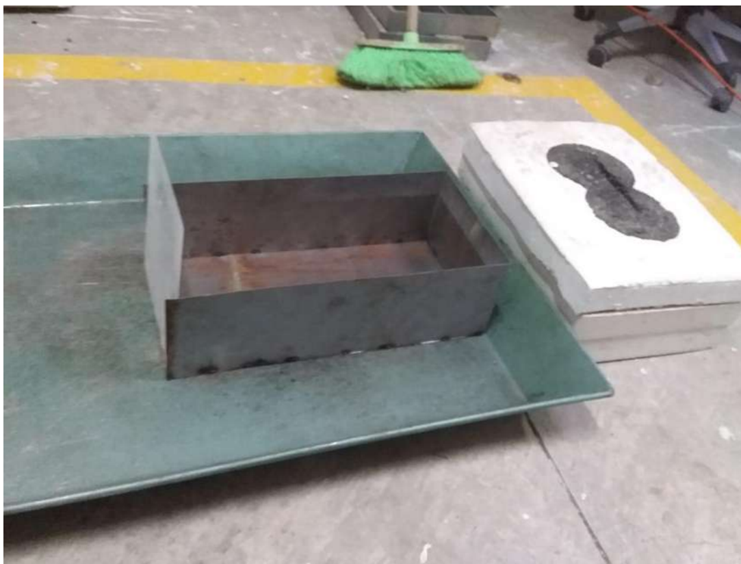
Figura 9. Modelo a escala 1:10 de la caja de un camión transportador. Fuente: imagen capturada por autor.
