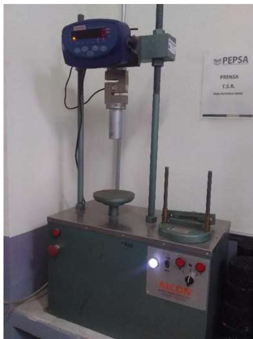
Figura 27. Prensa “Marshall” y una mordaza Lottman para el ensayo TSR (propiedad de PEPSA). Fuente: Captura propia.
