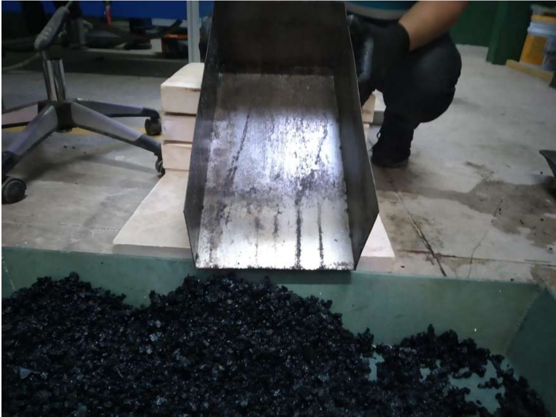
Figura 10. Simulación del proceso de descarga de la mezcla asfáltica, mediante el modelo a escala. Fuente: imagen capturada por autor.
