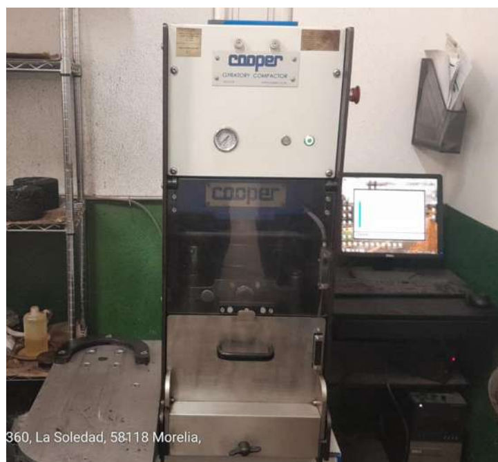
Figura 26. Compactador Giratorio para la densificación de especímenes de prueba (propiedad de PEPSA). Fuente: Captura propia.
