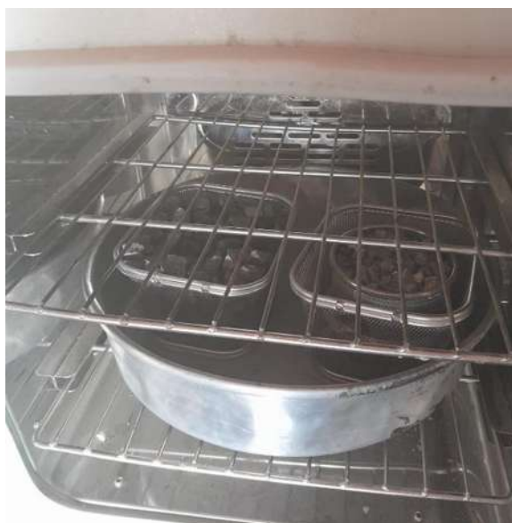
Figura 5. Ciclo de inmersión y secado de las muestras de agregado. Fuente: imagen capturada por autor.
