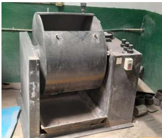
Figura 4. Imagen y esquema representativo de la máquina de los ángeles. Fuente: imagen capturada por autor y esquema tomado del Manual de ensayos del IMT.
