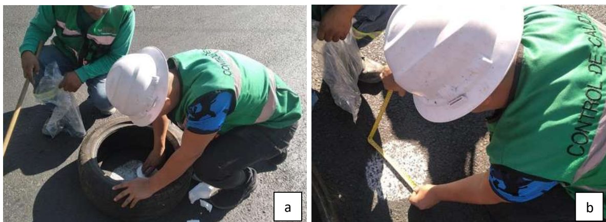
Figura 31. Determinación de la PMT mediante el círculo de arena. Fuente: Captura propia.
