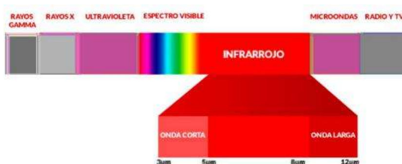
Fig. 12. Espectro infrarrojo de la luz [43].
