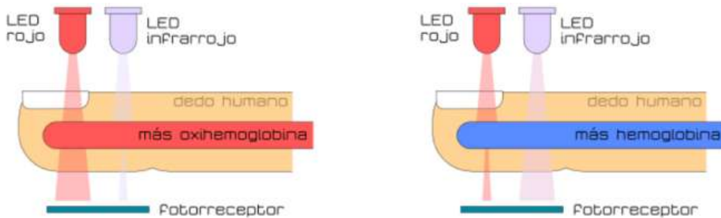
Fig. 24. Ilustración de absorción de luz por el cuerpo [73].
