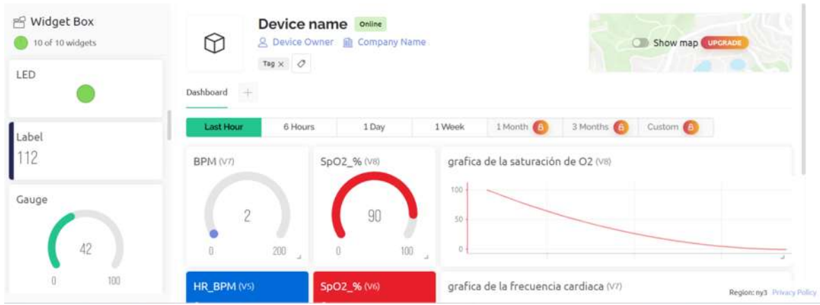
Fig. 49. Configuración de widgets de la Interfaz web de Blynk.
