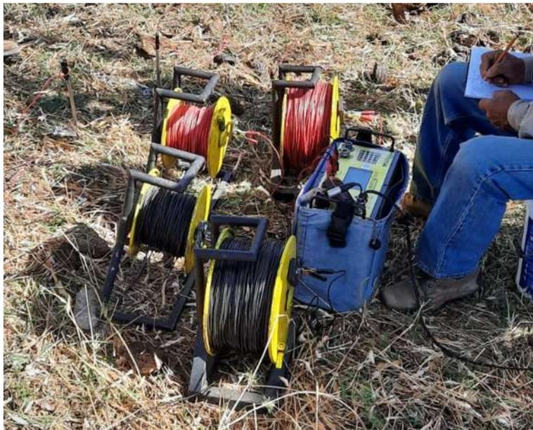
Figura 19. Equipo utilizado para tomografía eléctrica.
