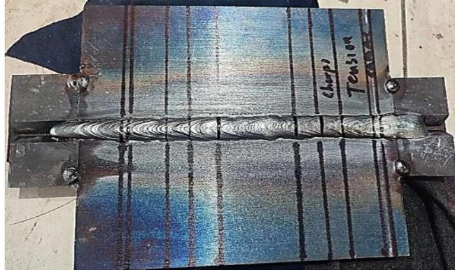
**Figura 3.7** Trazo de placas para probetas de ensayos mecánicos.
