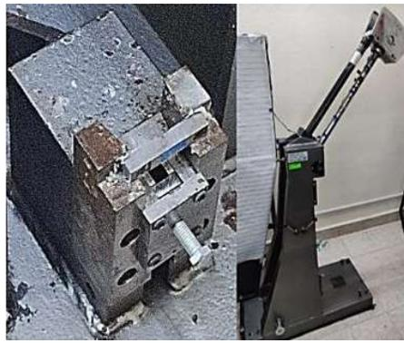
**Figura 3.12** Equipo para realizar los ensayos de impacto, péndulo instrumentado.
