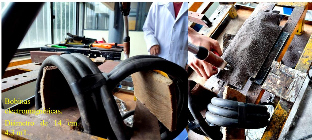
**Figura 3.3** Orientación de las bobinas durante el proceso de soldadura.
