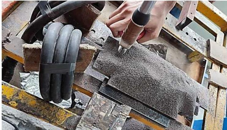
**Figura 3.4** Soldadura con la interacción de los campos electromagnéticos.
