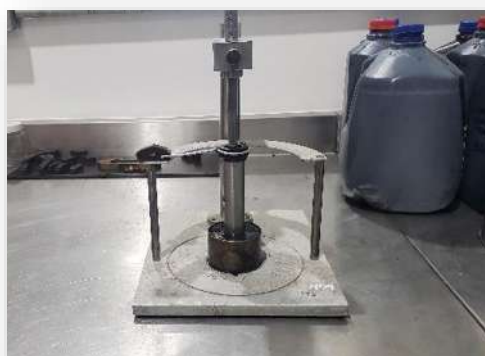
Ilustración IV-25. Equipo utilizado para ensayo de recuperación elástica por torsión.
