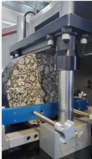
Ilustración IV-39. Probeta sometida a ensayo de ITT.
