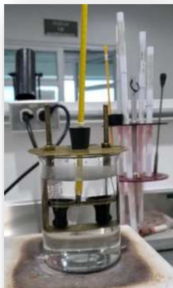
Ilustración IV-23. Equipo utilizado para ensayo de reblandecimiento y separación anillo y esfera.
