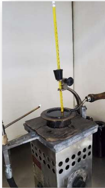
Ilustración IV-22. Ejecución de prueba puto de inflamación Cleveland.
