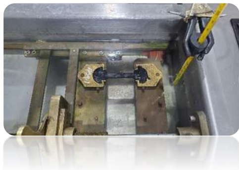
Ilustración IV-28. Ejecución de ensayo de recuperación elástica en ductilómetro.
