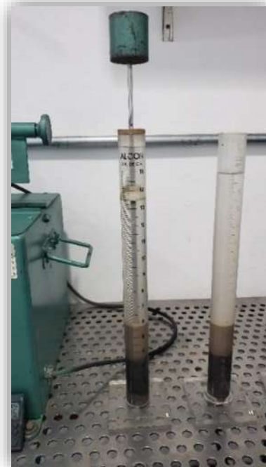
Ilustración IV-12. Lectura del ensayo equivalente de arena.
