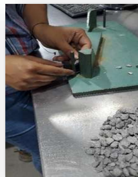
Ilustración IV-21. Ejecución de ensayo forma de la partícula.
