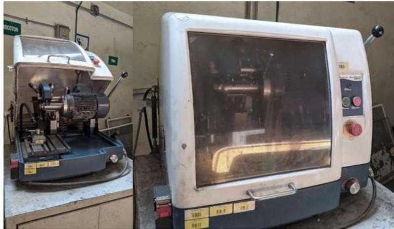
**Figura 3.6** Cortadora metalografica Buehler® modelo AbrasiMet 250.
