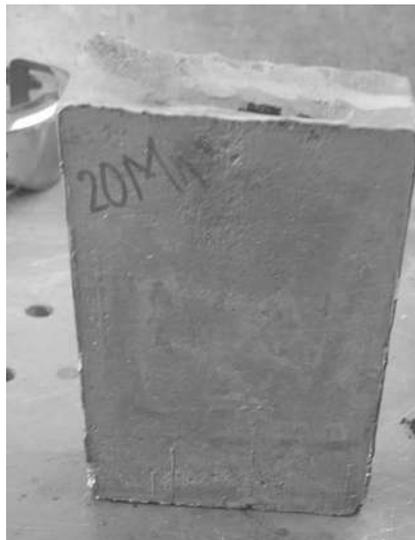
**Figura 3.5** Lingote después de ser extraído del molde.
