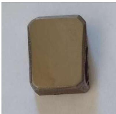
**Figura 3.7** Muestra cortada para caracterización en condiciones de colada.
