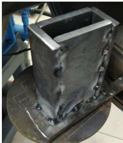
**Figura 3.3** Molde metálico (lingotera) para el vaciado del metal.
