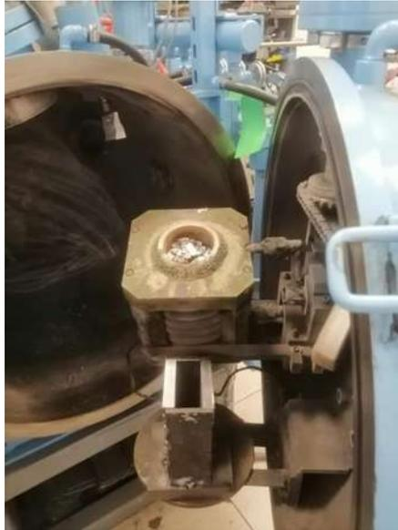
**Figura 3.4** Crisol y lingotera dentro del horno de inducción al vacío.
