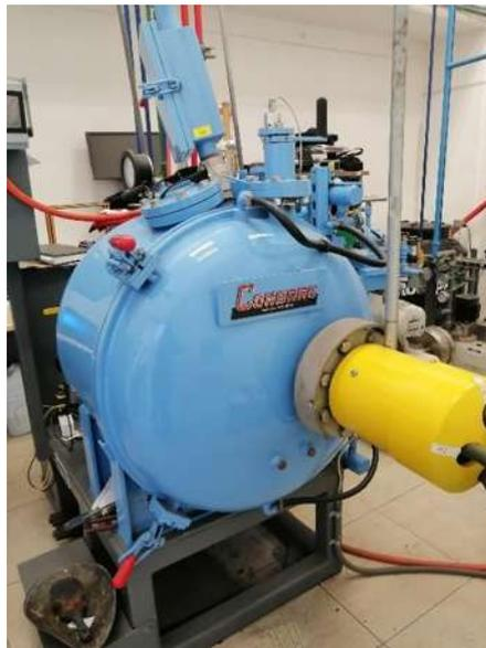
**Figura 3.2** Horno de inducción con cámara de vacío de la marca Consarc.
