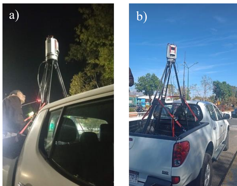
Figura 17. Imágenes de campo. a) y b) Posicionamiento del escáner terrestre para la obtención de nubes de puntos sobre el segmento de estudio.
