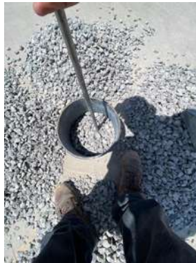
Figura 12.- compactación del agregado grueso. Ilustración propia
