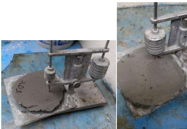
Figura 6 Determinación de los tiempos de fraguado con las agujas de Gilmore. Por Luis Alberto González
