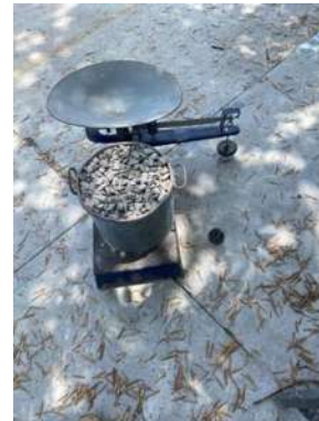
Figura 13.- Toma de la lectura de la masa del agregado grueso más el recipiente. Ilustración propia
