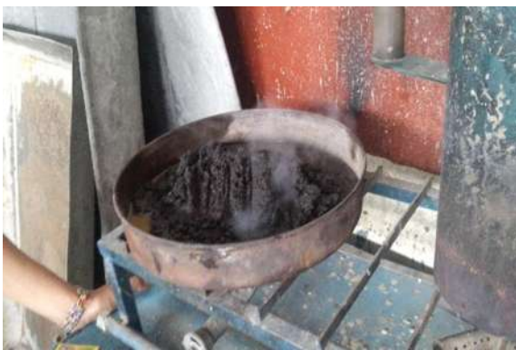
Figura 17. Una muestra de agregado fino que se puso en calor para que perdiera humedad. Por Luis Alberto González
