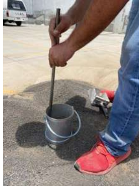
Figura 9.- Proceso de compactación del agregado fino. Ilustración propia
