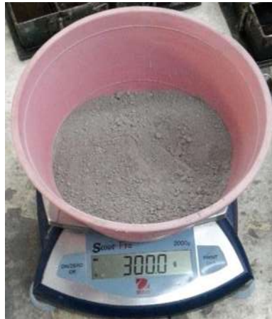
Figura 27 Obtención de los 300g de cemento. Por Luis Alberto González
