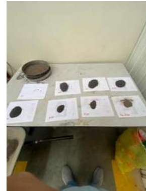
Figura 16.- Distribución de las partículas de las distintas mallas. Ilustración propia
