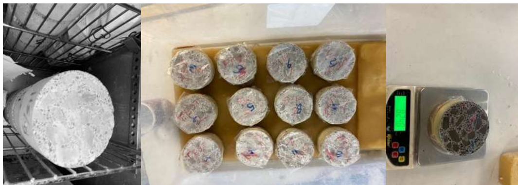
Figura 38 ejecución de la prueba de absorción capilar en elementos de concreto. Fuente propia
