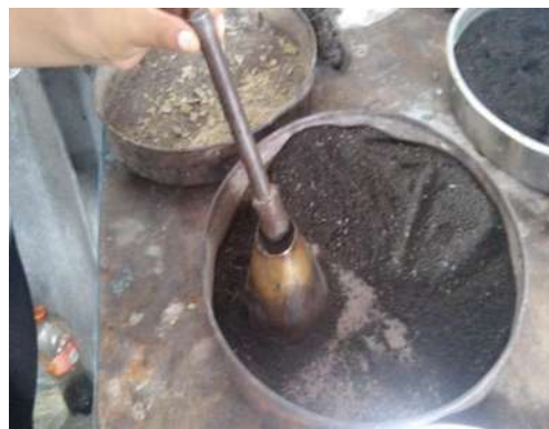
Figura 18. Prueba del molde troncocónico. Por Luis Alberto González
