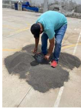
Figura 3.- Llenado y enrasado del agregado fino. Ilustración propia
