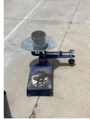
Figura 10.- Toma de la lectura de la masa del agregado más el recipiente. Ilustración propia
