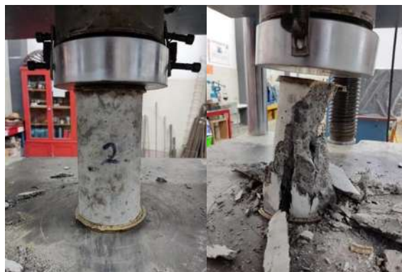
Figura 34 prueba de compresión en cilindros de 10 cm de diámetro. Fuente propia
