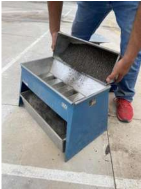
Figura 14.- Cuarteo del agregado fino para la prueba de granulometría. Ilustración propia
