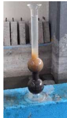
Figura 25. Relleno de agua hasta la marca de 400 ml. Por Luis Alberto González
