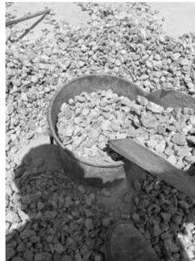
Figura 6.- Llenado del recipiente con agregado grueso. Ilustración propia
