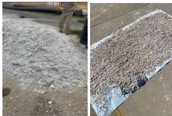
Figura 40 extracción y secado del subproducto de la geotérmica. Fuente propia
