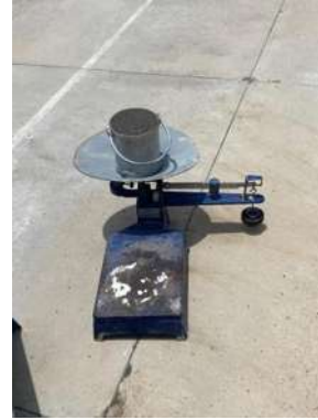
Figura 4.- Toma de la lectura de la masa del agregado más el recipiente. Ilustración propia
