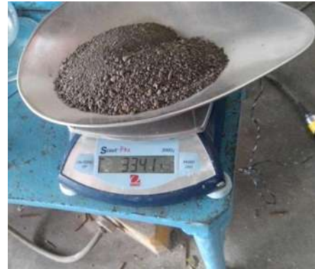
Figura 20. Determinación del peso seco del agregado. Por Luis Alberto González
