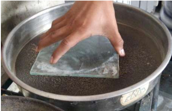
Figura 19. Obtención de la humedad por medio del cristal. Por Luis Alberto González
