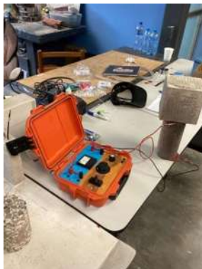
Figura 32. Ejecución de la resistividad eléctrica en una muestra cilíndrica. Fuente propia
