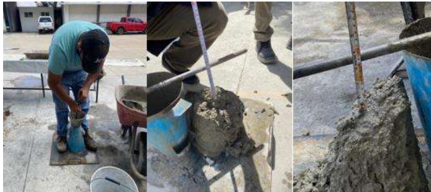
Figura 29. Prueba de revenimiento.
