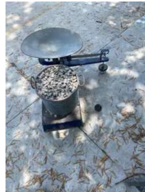
Figura 7.- Toma de la lectura de la masa del agregado grueso más el recipiente. Ilustración propia
