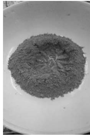
Figura 28 Colocación del cemento en la capsula para mezclar con el agua. Por Luis Alberto González
