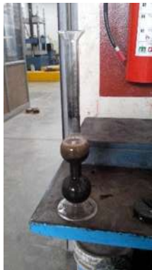
Figura 24. Colocación del agregado y homogeneizado con el agua. Por Luis Alberto González
