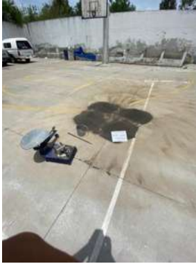
Figura 8.- Material cuarteado para prueba de masa volumétrica. Ilustración propia
