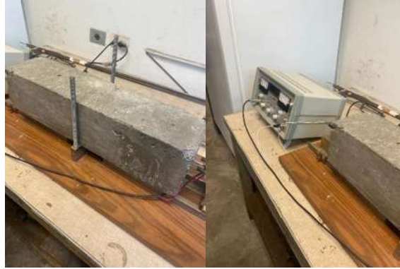
Figura 33 prueba de frecuencia de resonancia en vigas. Fuente propia
