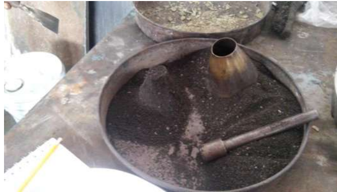
Figura 21. El agregado está en estado óptimo para la realización de la prueba. Por Luis Alberto González
