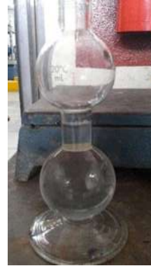
Figura 23. Vaso llenado con agua hasta la marca de 200 ml. Por Luis Alberto González
