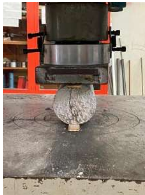
Figura 36 ejecución de la prueba de compresión diametral. fuente propia
