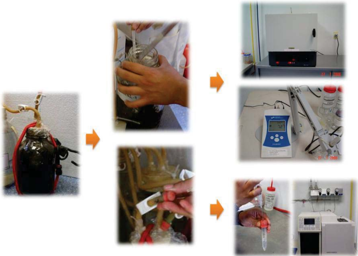
Figura 1. Operación y seguimiento del reactor de digestión anaerobia de sustrato sólido (RDASS): alimentación, muestreo de biogás y determinación de humedad, sólidos totales volátiles, pH y contenido de CH 4 en el biogás.
