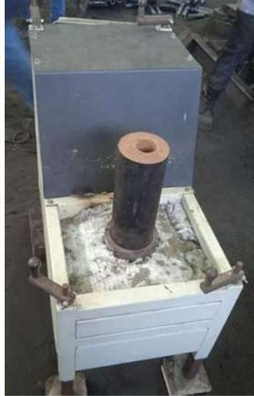
**Figura 3.4** Molde utilizado para la solidificación dinámica sujeto en la máquina vibratoria
