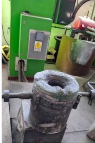
**Figura 3.2** Horno de inducción marca INDUCTOTHERM POWER TRAK modelo 50 LBS con capacidad de 30 kilogramos utilizado para la fusión de las aleaciones de hierro.
