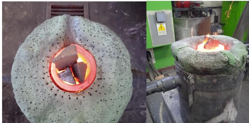
**Figura 3.5** Crisol cargado con metal Sorel en proceso de fusión
