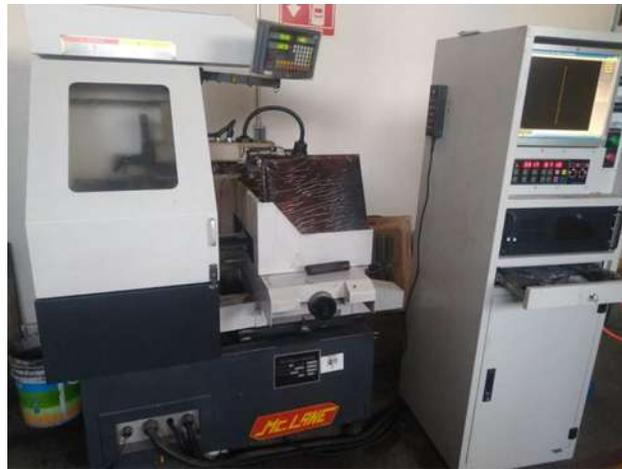
**Figura 3.7** Máquina de electroerosión por hilo con hilo de tungsteno marca MC. LANE.
