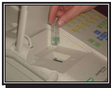
Fig. 5.5.3. Lectura de las muestras a una \lambda=600 nm en Espectrofotómetro
