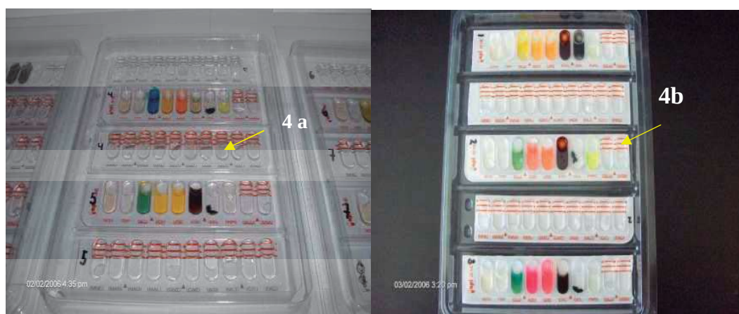
Figura 10. Sistema API-20C, para la identificación de levaduras del polvo precipitado del aire del exterior 4a) asimilación de nitrógeno orgánico y fuentes de carbono a 24h de incubación, 4b) 48h.
