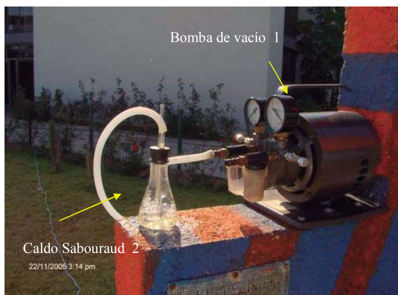
Figura 3. Método de burbujeo, para la detección de Candida spp en el polvo del aire del exterior en Ciudad Universitaria de Morelia, Mich.
