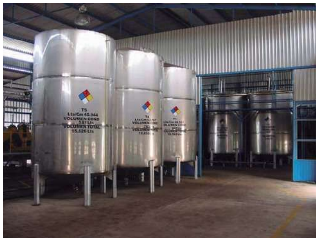
Fig. 13 .Tanques de acero inoxidable con un volumen de 15,000 litros Fábrica Embajador Jalisciense
