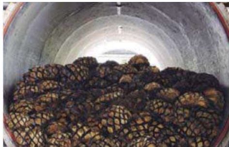
Figura 6. Acomodo de las piñas dentro de la autoclave
