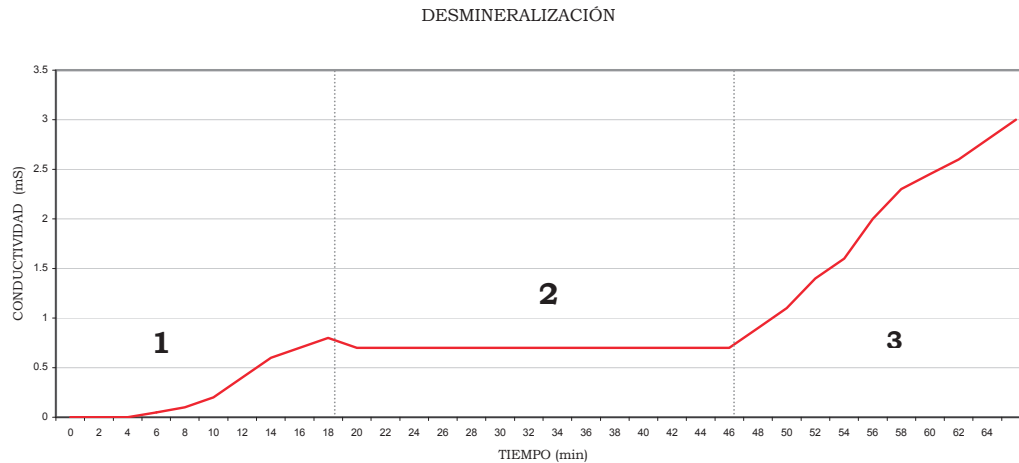
Fig. 11 Gráfica de conductividad del jugo a la salida de las columnas.
