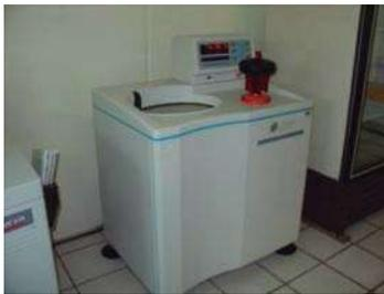
Fig. 20 Ultracentrífuga
