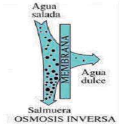
Fig. 4 Diagrama representativo del método de osmosis inversa
