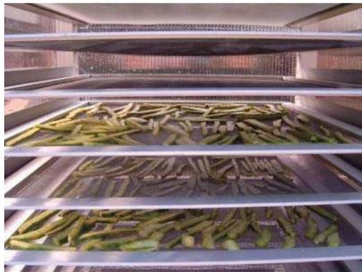
**Figura 9. Nopal colocado en bandejas del deshidratador solar.**
