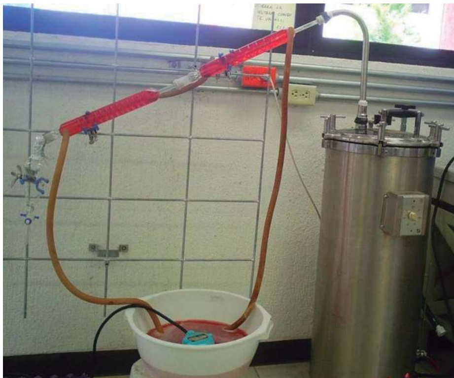
Figura 4. Equipo de destilación por arrastre de vapor
