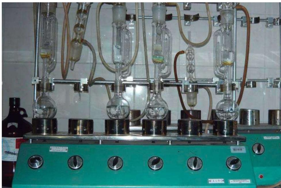
**Ilustración 3. Equipo Soxhlet, para determinación de extracto etéreo.**
