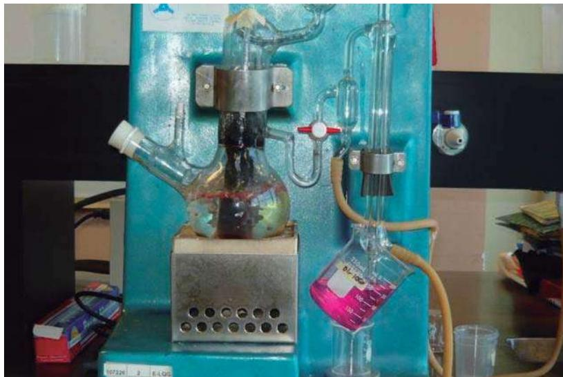
**Ilustración 2. Equipo Micro-Kjeldhal. Proceso de destilación de Proteína.**
