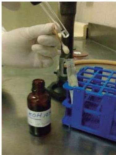
Fig. VIII. Realización de la prueba de aminas.
