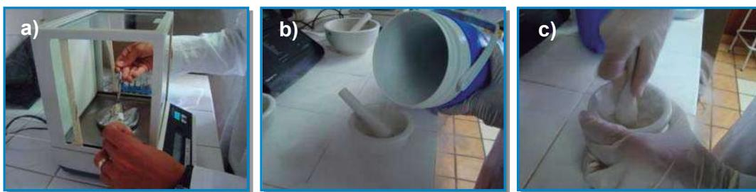
**Figura 26.** Preparación del extracto de G6PDH: a) Pesada, b) Adición de  $N_2$  líquido y c) Levigado.
