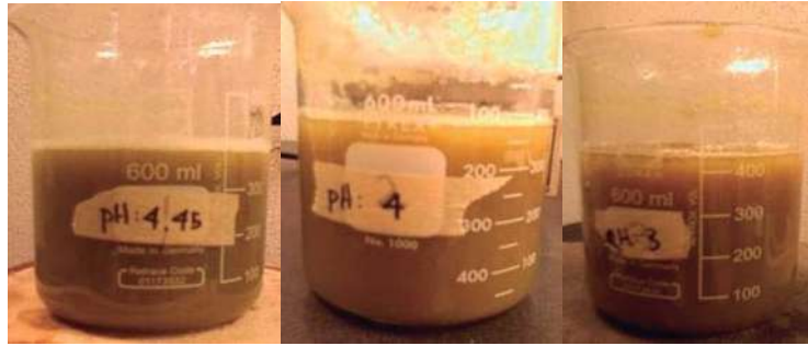
Figura 9. Mezcla de nopal a diferente pH después del calentamiento a 82 °C por 1h.
