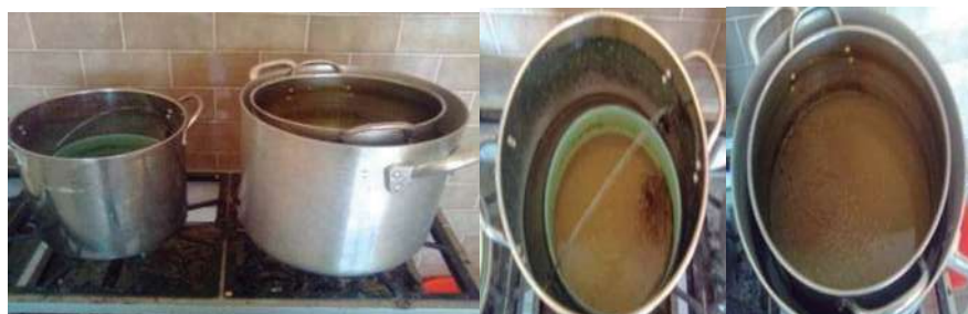
Figura 29. Concentración en baño María de mucílago existente en el sobrenadante.
