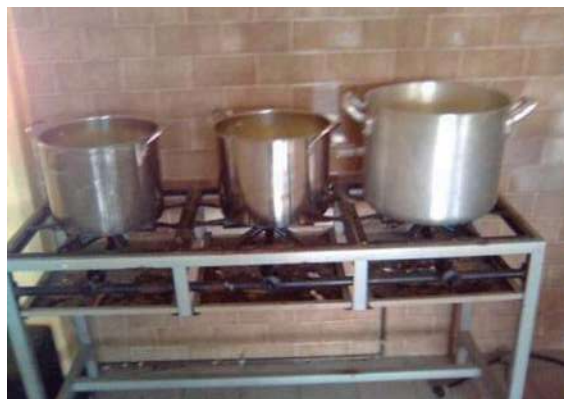
Figura 27. Calentamiento de la mezcla de nopal y agua destilada 82 \pm 2^{\circ}\text{C} por 1h.
