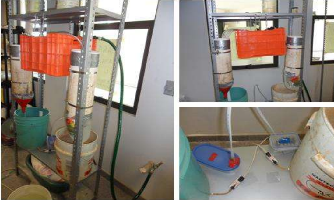
Figura 12.-Sistema para medición de la conductividad hidráulica saturada diseñado para los núcleos de suelo.
