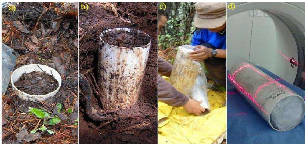
Figura 6.- a) el tubo de PVC insertado en el suelo, b) se excava la tierra alrededor del tubo, c) se envuelve en plástico para su traslado a laboratorio, d) escaneo del núcleo.
