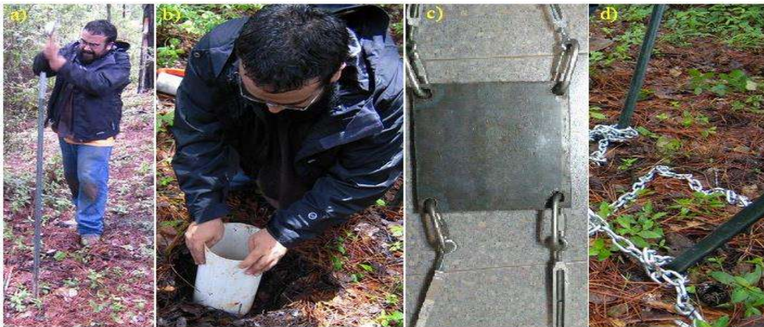
Figura 5.- Funcionamiento del sistema hidráulico extractor de núcleos, a) colocación de los postes, b) acomodo del tubo de pvc, c) colocación de bandolas y tensores, d) anclaje de cadena a poste ganadero.
