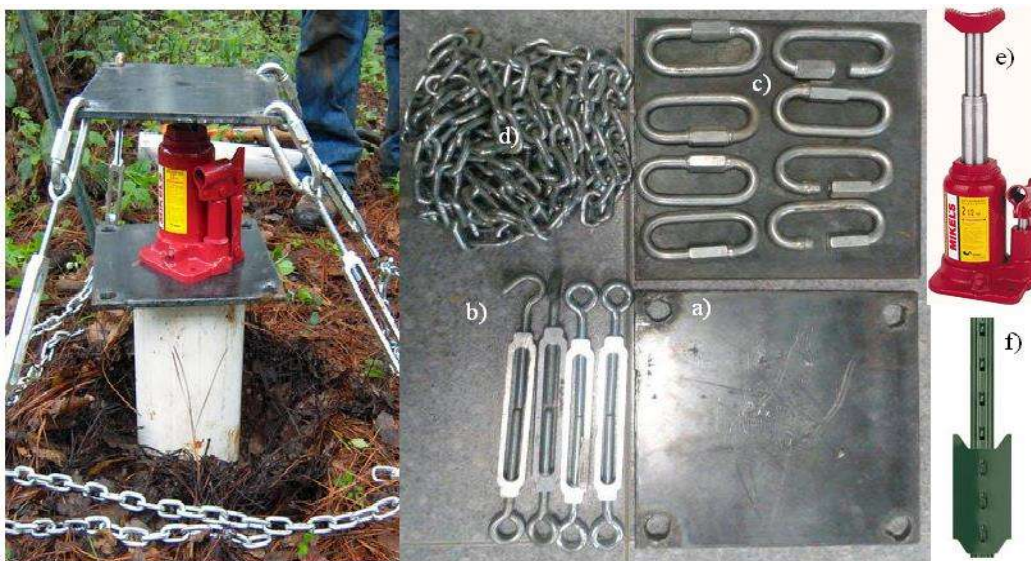
Figura 4.- Sistema hidráulico de extracción de núcleos, a) placas de metal, b) tensores, c) bandolas, d) cadena, e) gato hidráulico, f) poste ganadero metálico.
