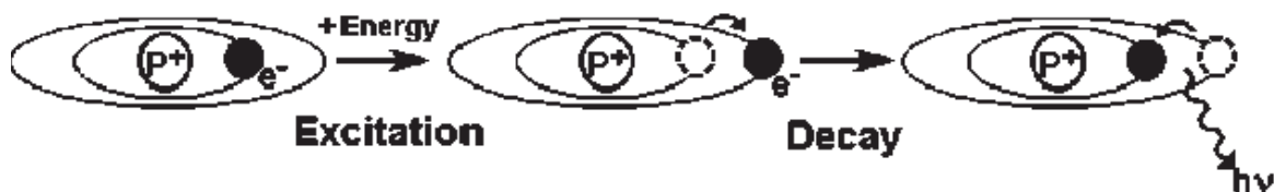
Figura A-5 Excitación electrónica de los átomos para su identificación por ICP
