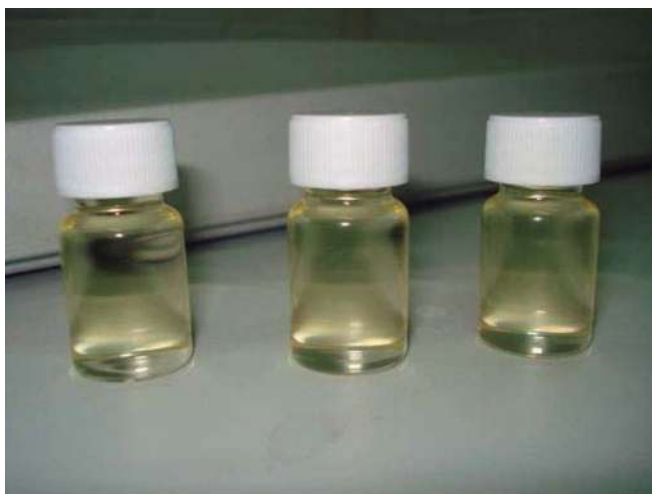
Biodiesel en la forma final después del lavado y un centrifugado por 10 minutos a 10000 rpm.
