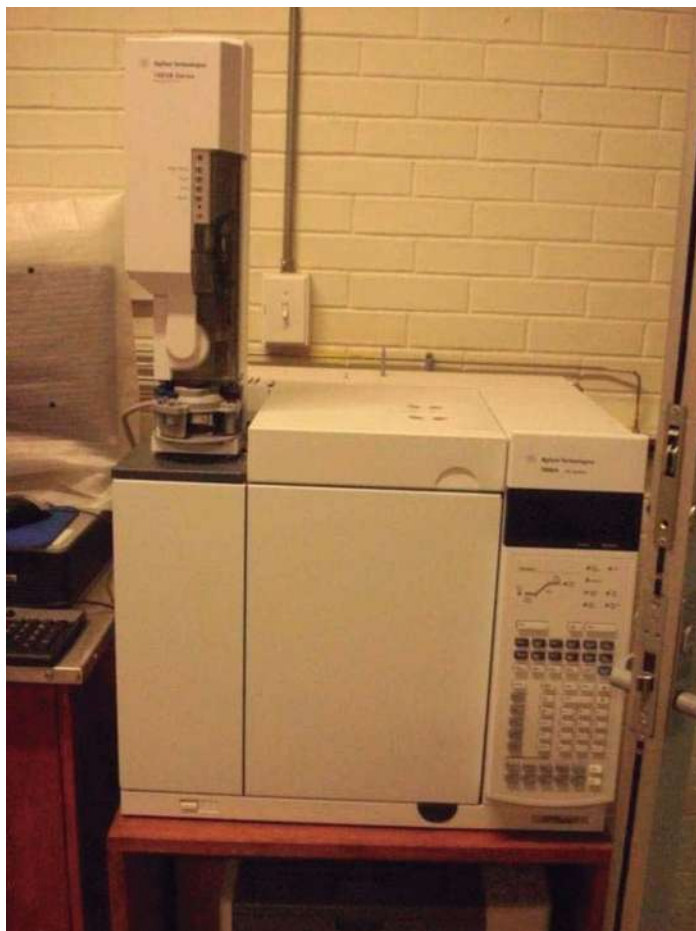
Figura 18. Cromatógrafo de gases con inyector automático Agilente technologies 7890A G6 system.
