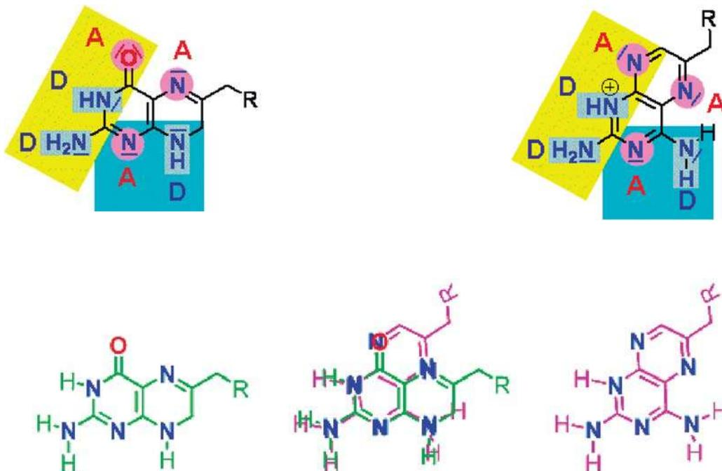
FIG VII. PATRON DE DONADORES Y ACEPTORES DE PUENTES DE HIDROGENO EN MOLECULAS DE MTX Y THF
