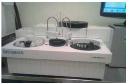
FIGURA 3.3.1 Representación del instrumento de trabajo analizador EMIT Viva “E”
