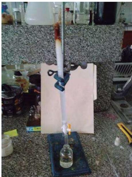
**Figura 19. Purificación de la Acetil Medicarpina en columna cromatográfica.**
