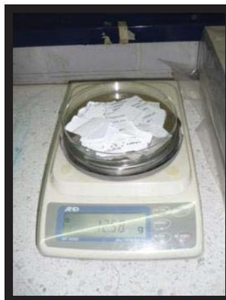
**Figura No. 6.** Balanza analítica (determinación de humedad)
