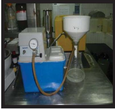
**Figura No. 11.** Bomba de vacío
