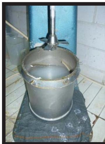
Figura No. 8 Desintegrador con pulpa
