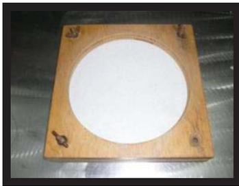
**Figura No. 13.** Obtención de una hoja del embudo Buchner
