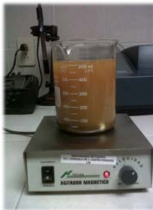
Ilustración 12. Modificación de la semilla de guayaba con \text{FeCl}_3 .
