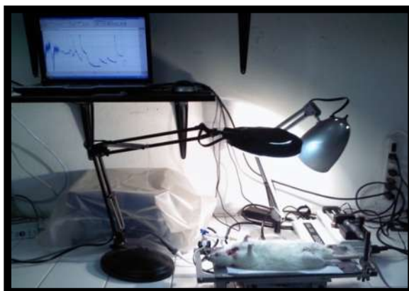
Figura 10. Medición de la presión arterial. Se observa el transductor de presión acoplado al sistema de adquisición de datos.
