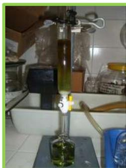
**Figura 8.** Cromatografía en columna de la fracción 5-6 del extracto hexánico.
