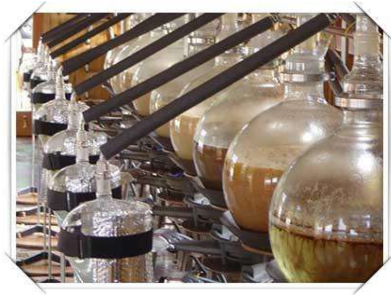
Figura 17. Destilación por arrastre de vapor, el vapor es forzado en un tanque de material vegetal, donde descompone y rompe las glándulas para liberar el preciado aceite (Warber, 2006).
