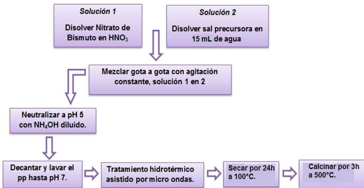
Figura 3.2 Diagrama general de síntesis de \text{Bi}_2\text{MoO}_6
