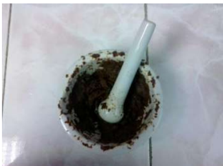
Figura 4. Método por el cual se sometió la muestra a una reducción de partícula
