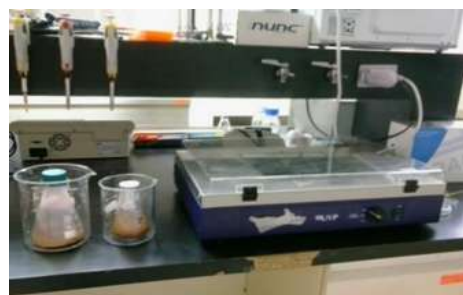
Figura 9. Cama ultravioleta, la cual fue utilizada para la esterilización del sustrato.
