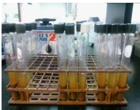
Figura 7. Tubos de caldo Lauril Sulfato de Sodio, que definirá el tiempo de esterilización por radiación UV.
