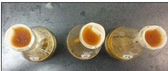
Ilustración 27.- Filtración de pectina
