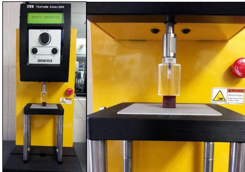
Ilustración 10.-Texturómetro CT3 y aditamento TA-RT-KIT
