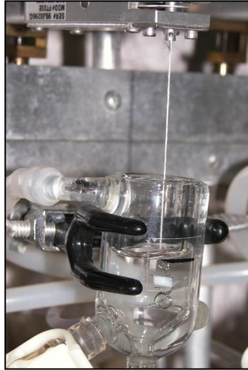
Figura #5. Cámara de tejido aislado. Proporciona condiciones necesarias para que el tejido sea viable para su estudio. Registra los cambios de tensión mediante un transductor, acoplado a un sistema de adquisición de datos.
