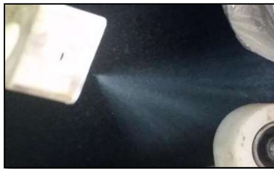
Figura 17 Formación coaxial del cono de Taylor
