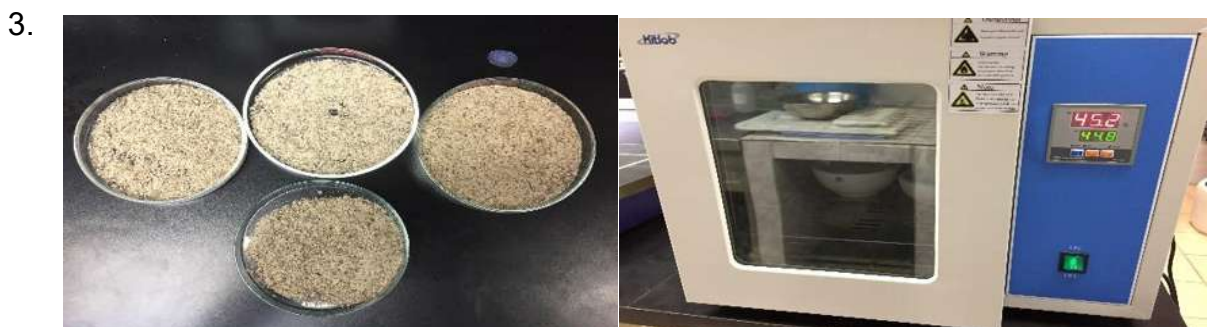
Figura 15. Muestra pulverizada y llevada a secado a 55°C. (Zaragoza R. R. et al., 2018)
