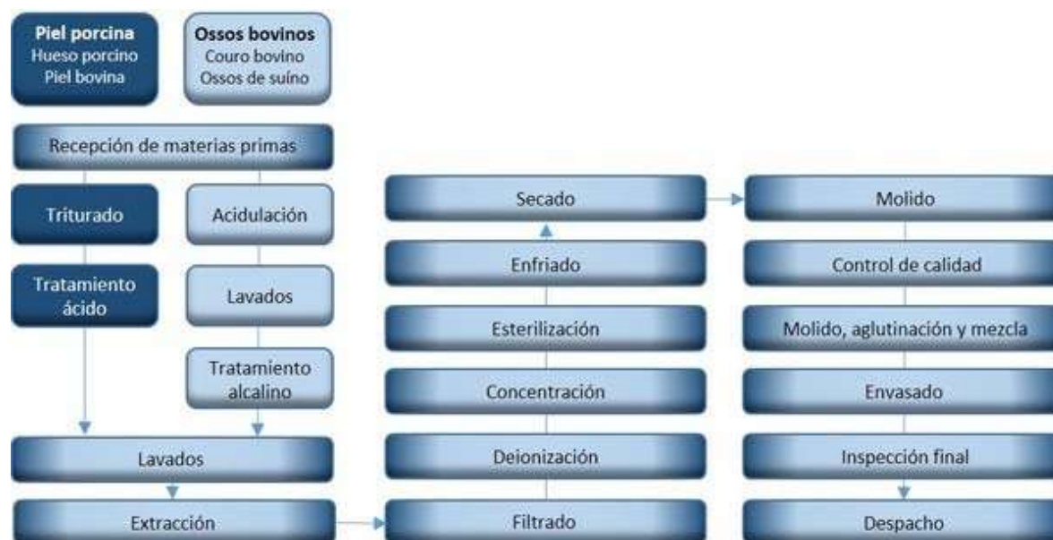
Imagen 2 Proceso de fabricación de la gelatina. Fuente: Rousselot.com
