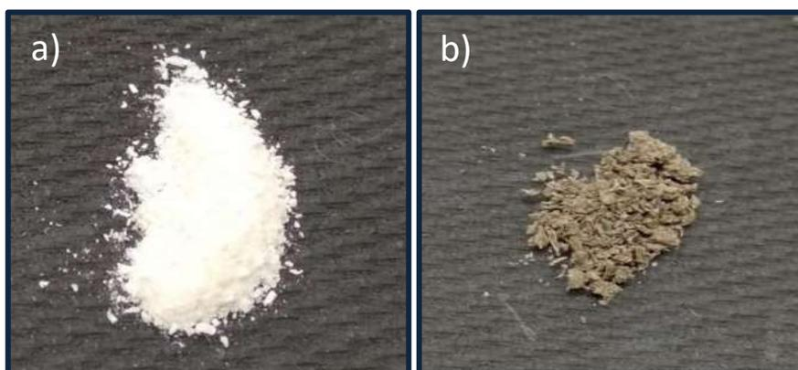
*Figura 24. Fotografías del material en forma de hojuelas. a) Hojuelas de CTS puro, b) hojuelas de CTS soportando al material de  $\text{Cu}_2\text{O}$ .*
