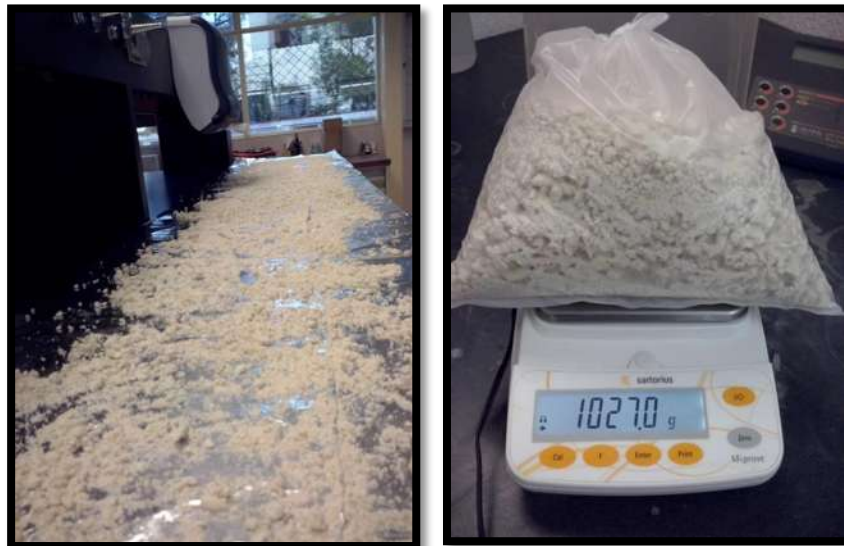
Figura 7 Proceso de deshidratación de la masa para la obtención de HMN
