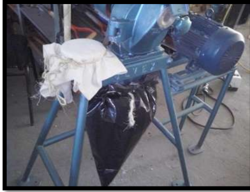
Figura 8 Reducción del tamaño de partícula a 0.25 nm en molino eléctrico Pulvex®
